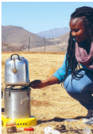
Der Hybrid-Solar-Biomasse-Kochherd spart Brennstoff und erzeugt Strom.
